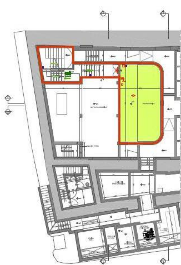
Percorso di esodo – Pianta piano interrato
